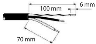
Dénuder les conducteurs de 5 à 6 mm de manière à ne pas risquer d'entrer en contact avec d'autres fils ou des parties métalliques. Le fil de terre (vert jaune) devra être plus long que les autres. La gaine du câble doit être présente jusqu'au bornier pour éviter tout risque de chocs électriques. Brancher l'appareil seulement si la tension et la fréquence correspondent à celles indiquées sur la plaque firme.
