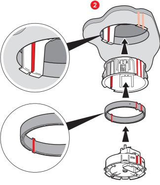
Aligner et pousser la bague de verrouillage dans le fond de la boîte avec la fonction (DCL, spot...)
