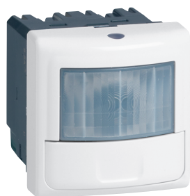
Détecteur Infrarouge Fixation au mur en encastré sur support Programme Mosaic, IP41 Détection 180° zone 6 m x 8 m
