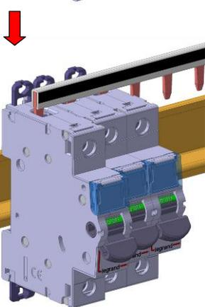
Tirer l'appareil vers l'avant afin de le dégager du rail
