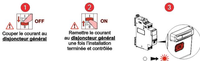
. 3/ Appuyer plus de 3 secondes sur le bouton de configuration du Module Control, OU au centre de la commande générale sans-fil Départ/Arrivée jusqu'à ce que le voyant s'allume brièvement en vert, puis relâcher l'appui.
