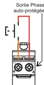
Soit par bouton poussoir envoyant la phase protégée par un disjoncteur sur la borne C1
