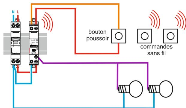
. Installation sans fil avec plusieurs commandes sans fil « with Netatmo » pilotant un téléinterrupteur (voir page 6 pour l'association de commande sans fil) :
