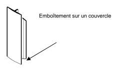
Le joint de couvercle se glisse et se positionne sur l'extrémité d'un couvercle, l'autre côté reste disponible pour réouverture
