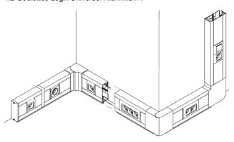
La gamme Logix universel Aluminium, système de goulottes aluminium, permet une solution esthétique et résistante dans les environnements tertiaires.
