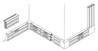
La gamme Logix 45 Aluminium, système de goulottes aluminium, est dédiée aux installations tertiaires.
