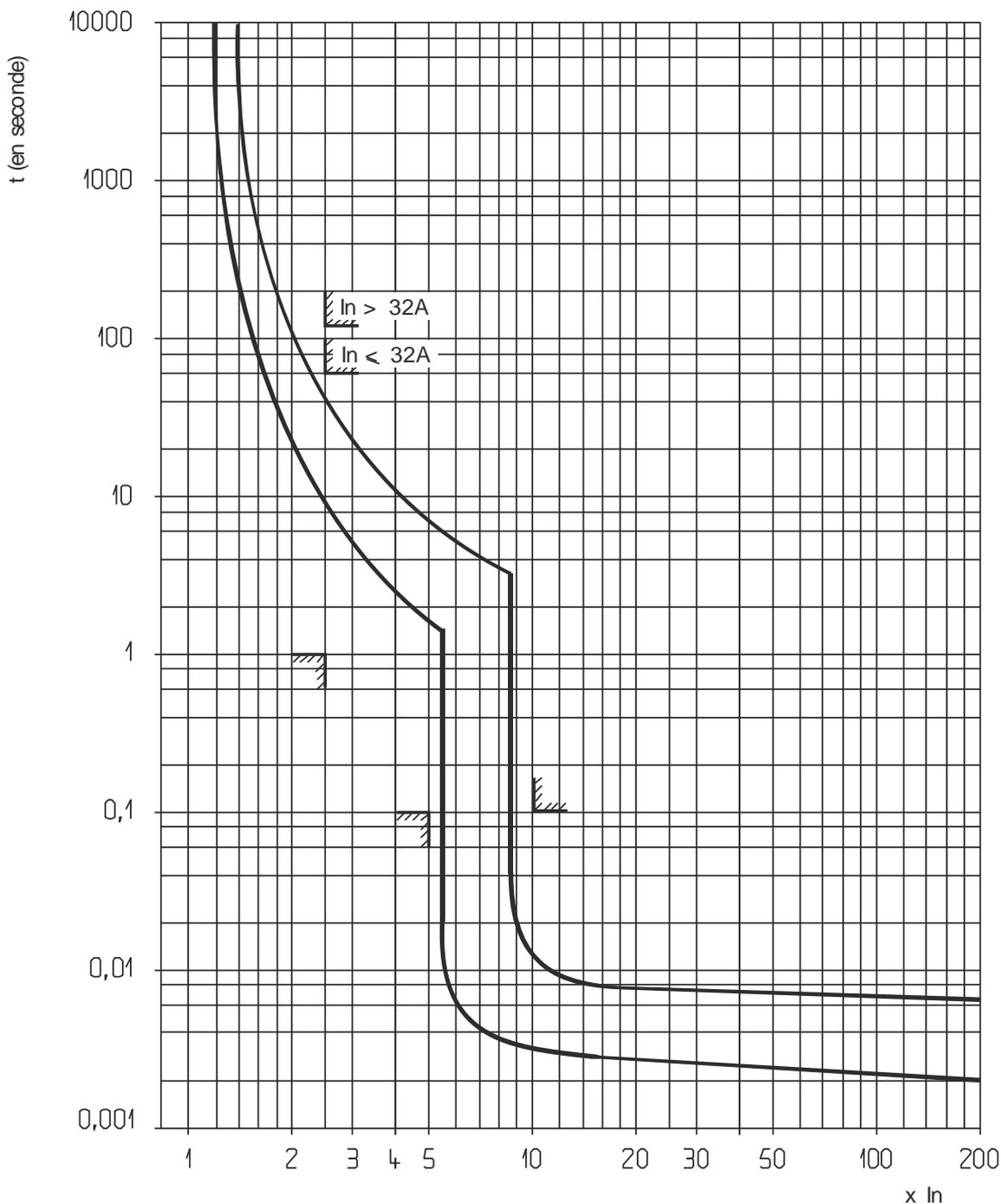
Déclenchement thermique temp. ambiant = 30°C
